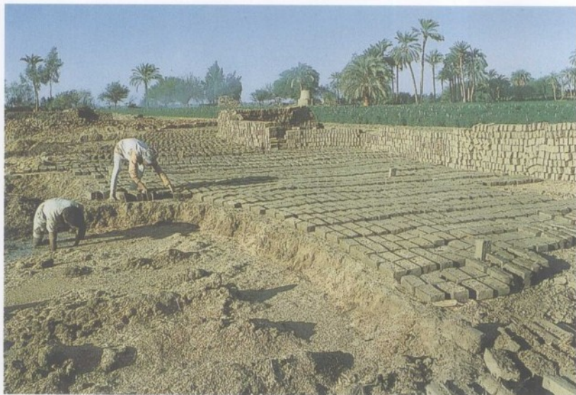
开罗城外的一座现代化“砖厂”仍然使用古老的方法和材料：取自尼罗河的泥土，让炎热的太阳晒干砖块。
