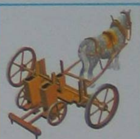
杰思罗·塔尔的种子条播机(上) 塔尔的“马耕法”(1733年)所示图样,这种机器逐渐代替了费事的手工撒播。
